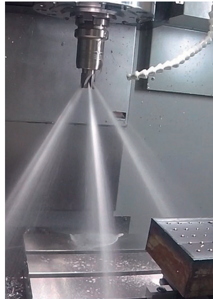
3 In Praxisversuchen werden Kühl- und Spänefluss für verlängerte Standzeiten validiert
